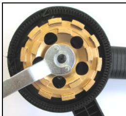
Achten Sie darauf, dass der Bund der Spannmutter wie im Bild dargestellt nach außen zeigt.
