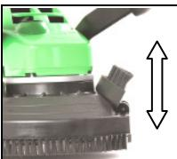
Pour effectuer des travaux contre des parois, on peut retirer la partie avant du capot anti-poussière à l'aide de la clé adaptée. Ceci permet de travailler dans des endroits difficilement accessibles.
