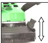
Kenar ve köşe bölgelerde çalışabilmek için toz korumasının belirli bir kısmı açılabilir ve bu şekilde bu köşelere ulaşılabilir.
