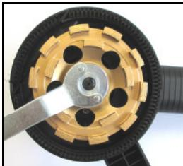
Veillez à ce que le bord de l'écrou de serrage soit dirigé vers l'extérieur, conformément à la figure.
