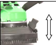
Für Schleifarbeiten unmittelbar an Wandkanten kann ein Segment der Schutzhülle geöffnet werden. Dies ermöglicht eine Bearbeitung auch von sonst unzugänglichen Stellen.
