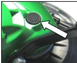
Betätigen Sie die Spindelarretierung und halten Sie diese gedrückt.
